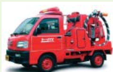
FRP軽積載消防車: 後部艦装をFRPにて形成し消防艦装を施したモデル
